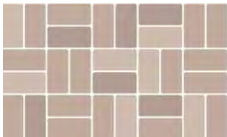
block- and parquet bond · Disposition en blocs et parquets
