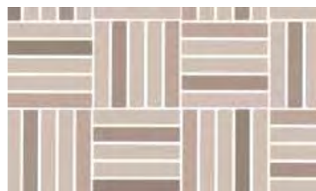
block bond · Disposition en blocs (barres)
