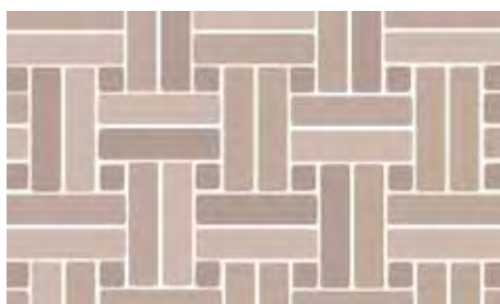
braiding bond · Disposition avec ajouts carrés
